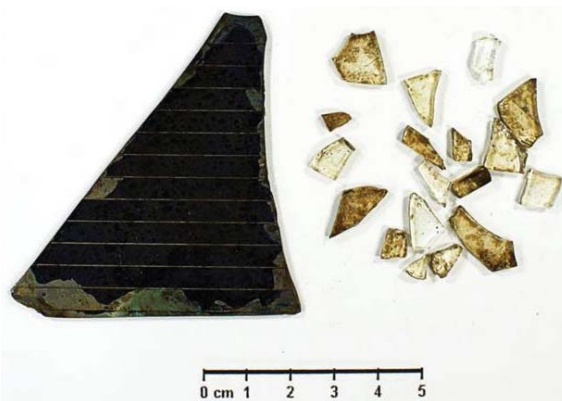
Abb. 5: Ergebnis der Pyrolyse – Trägerglas mit Halbleitermaterialien (li.) und Frontglas (re.).
