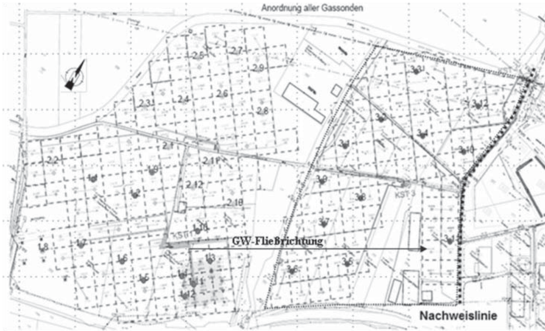
Abb. 1: Grundriss der Deponie Pill mit den 216 Belüftungsfeldern und den 35 Bodenluftmessstellen (3.1 bis 3.12 im rechten Feld). An der Nachweislinie erfolgt die Erfolgskontrolle der Belüftungsmaßnahme.
