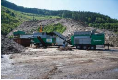
Abb. 1: Versuchsaufbau zur Grünschnittaufbereitung mit Zerkleinerer, Überbandmagnet und Steinabscheider.
