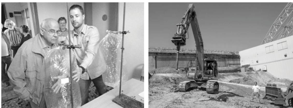
Abb. 2: Damien Kurc lässt freiwillige Anwohner, die am „Nasennetzwerk“ teilnehmen, eine in einem Spezial sack genommene, schwach konzentrierte Geruchsprobe der Deponie testen (links). Rechts: Beprobung des Deponiesaums zur Überprüfung, dass die vereinbarten Sanierungsziele erreicht wurden.
