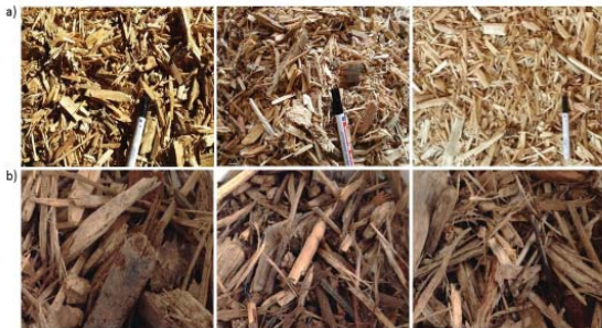
Abb. 1: Beispiele für analysierte Holzabfälle a) (oben) aufbereitete Holzabfälle, b) (unten) aufbereitetes Rechengut aus Kraftwerken.
