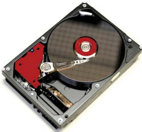
Abb. 2: Voice-coil Aktuator (links) und Spindelmotor (rechts) (nach Ueberschaar & Rotter 2014).
