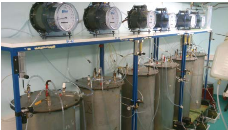
Abb. 3: Deponiesimulationsreaktoren an der TUHH zur Untersuchung des aktuellen und zukünftigen Emissionsverhaltens der Deponie Teuftal.
