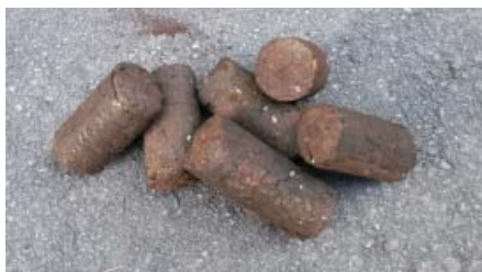
Abb. 3: Torrefiziertes Brikett Ø 70 mm aus Grünschnitt-Schredderholz.
