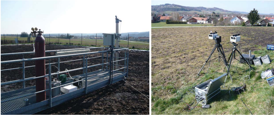
Abb. 2: Fotoaufnahmen während der Messung beim offenen Gärrestlager einer Biogasanlage (links: Tracergasfreisetzung für den Modellvergleich; rechts: CH 4 - und C 2 H 2 -Laser).
