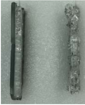
Abb. 6: Modul mit Front- und Trägerglas vor Schredder (li.) und nach Schredder ohne Trägerglas (re.).
