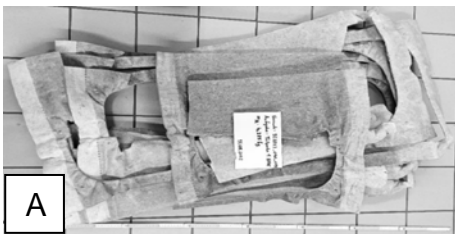
Abb. 1: A Naturfaserverstärkter Kunststoff ( 50% PP + 50 % Flachs) B Polypropylen
