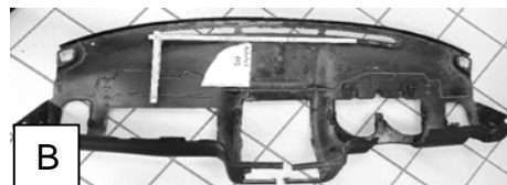
Abb. 1: A Naturfaserverstärkter Kunststoff ( 50% PP + 50 % Flachs) B Polypropylen
