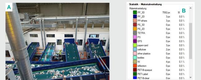
Blick in die Sortieranlagentechnik im Realversuch (A) und die Statistik der Materialverteilung für den Test der NFK im realen Abfallstrom
