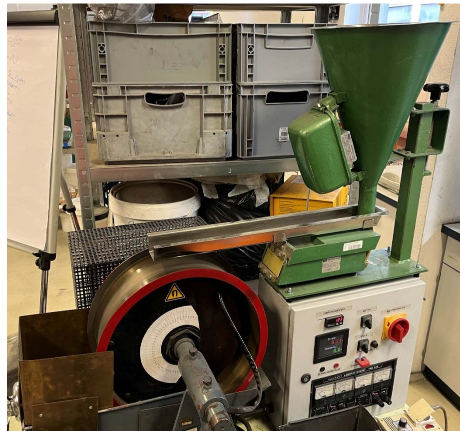
Magnetscheider mit einstellbarer Feldstärke
