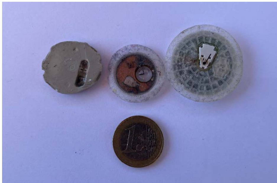
Rückseite der drei verschiedenen Sensoren. Von links: Dexcom G7, FreeStyle Libre 3 und FreeStyle Libre 2
