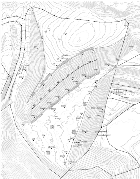
Abb. 2: Gesamtüberblick Deponie Leoben Seegraben mit vorgeschlagener Positionierung von Methanoxidationsfenstern (schraffiert) und PV-Unterkonstruktion an der Süd-Ost-Böschung
