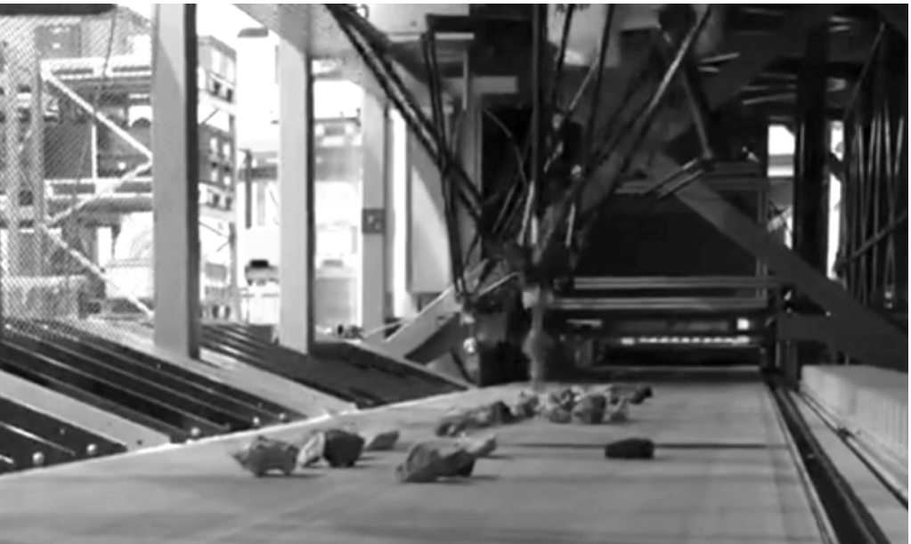
Abb. 5: Delta-Roboter greifen vereinzelte Feuerfeststeine auf einem Förderband (University Liège)
