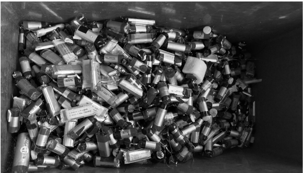
Abb. 2: Batterien aus Einweg-E-Zigaretten
