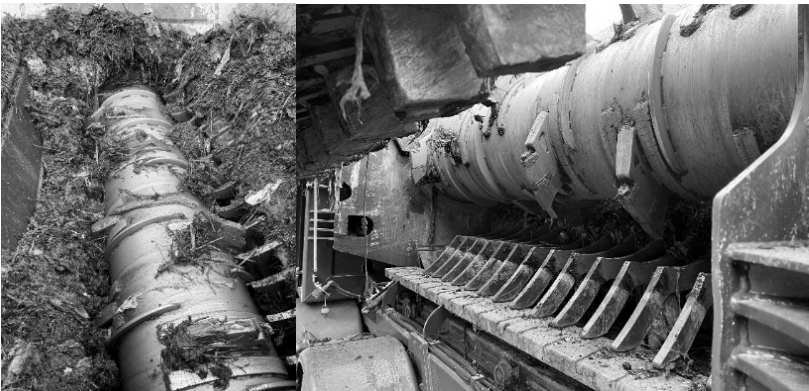
Abb. 1: V-Zerkleinerungseinheit des Terminator xtron
