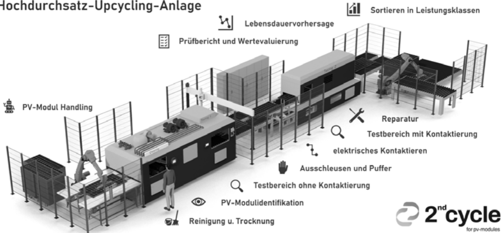
Abb. 1: Hochdurchsatz Upcycling-Anlage für gebrauchte PV-Module
