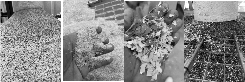
Abb. 3: Geschredderte Klumpen, Fines, PIR Folien Flakes, GAG Flakes
