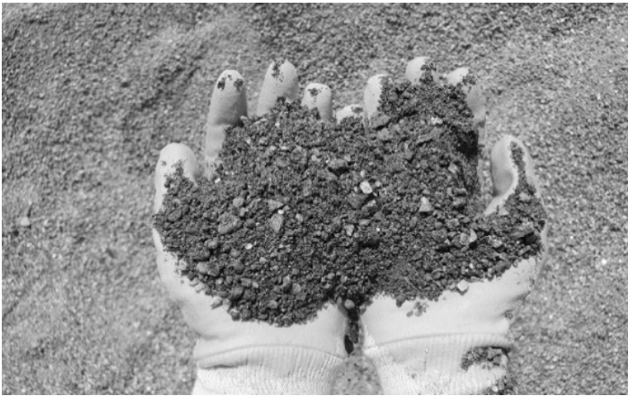
Abb. 2: industriell aufbereitete Gesteinskörnung „slagtory“ der Fa. Brantner
