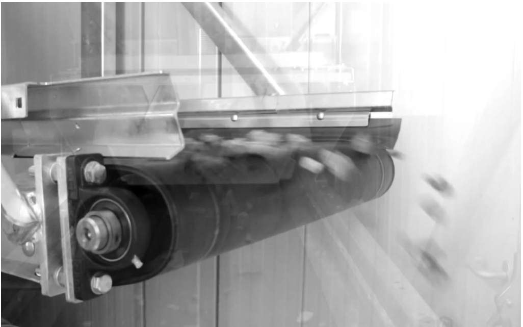
Abb. 7: Flugparabel der Feuerfeststeine am Bandkopf
