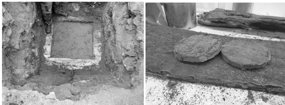
Abb. 4: Ausbauprobe im Schurf (links) und Proben für Permittivitätsbestimmung (rechts)
