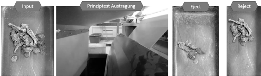
Abb. 1: Prinziptest der Austrageeinrichtung. Input: Gemisch aus Stahl- und Kupferpartikeln. Prinziptest Austragung: Expansionshaube und Austragsklappe. Eject: Ausgetragenes Kupfermaterial. Reject: Stahlfraktion.
