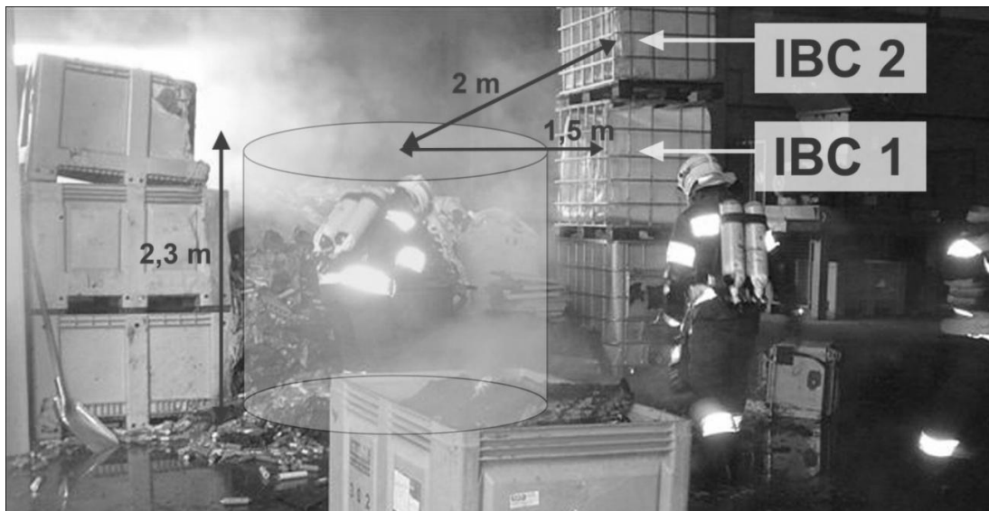
Abb. 4: Brand von lose gelagerten LIB (Rundzellen)
