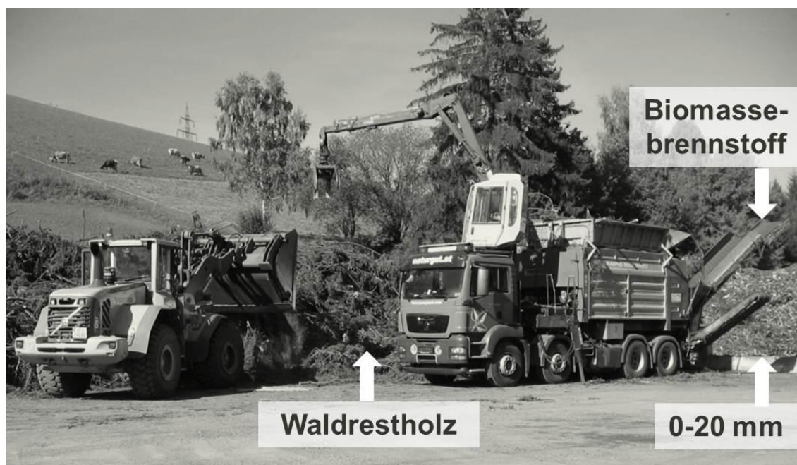
Abb. 2: Zerkleinerung und Siebung von Waldrestholz für den Versuch
