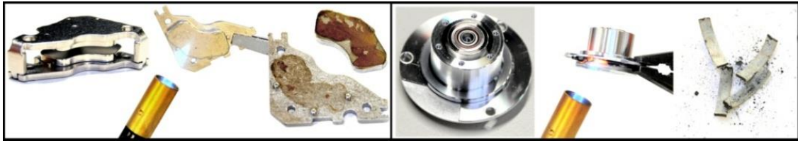
Abb. 2 Manuelle Demontage der Neodymmagneten aus Voice - Call Motor (oben) und aus Spindelmotor (unten) (eigene Aufnahme)
