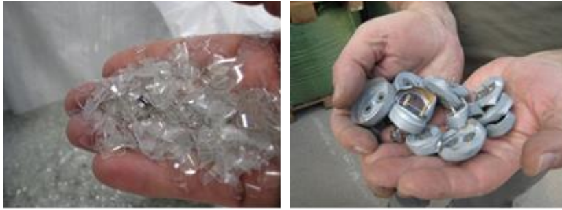
Abb. 6: gereinigtes Lampenglas und Alu-Endkappen
