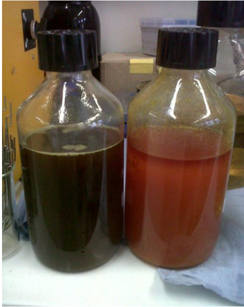
Abb. 2: Handelsübliches Palmkernöl nach (links) und vor (rechts) Exposition zu thermischem Stress unter Laborbedingungen (Foto © IFA-Tulln/Scherr).
