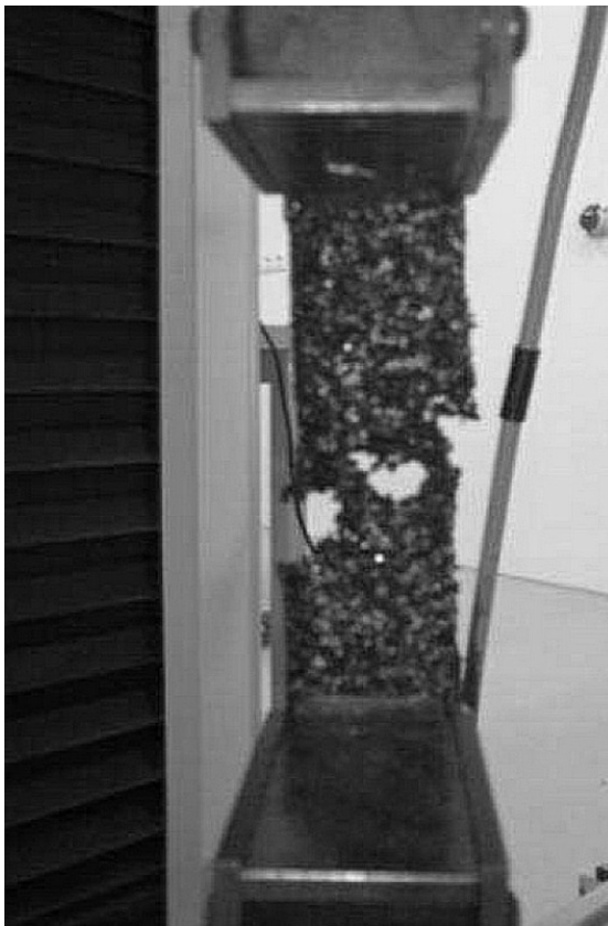
Abb. 1: Probekörper nach erfolgter Zugprüfung
