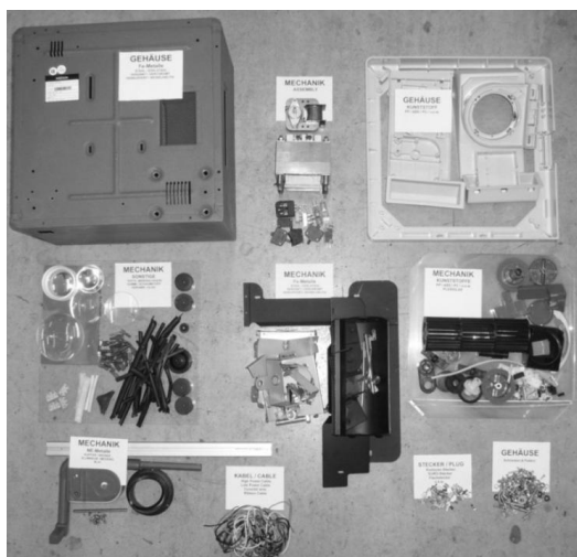
Abb. 3: Beispiel für eine Demontageanalyse (rechts) und ein generisches Produkt Modell von einem Projektor. Für jedes Gerät wurden folgende Informationen gesammelt: Materialgruppen, Materialzusammensetzung in % und Absolutgewicht inkl. Standardunsicherheit
