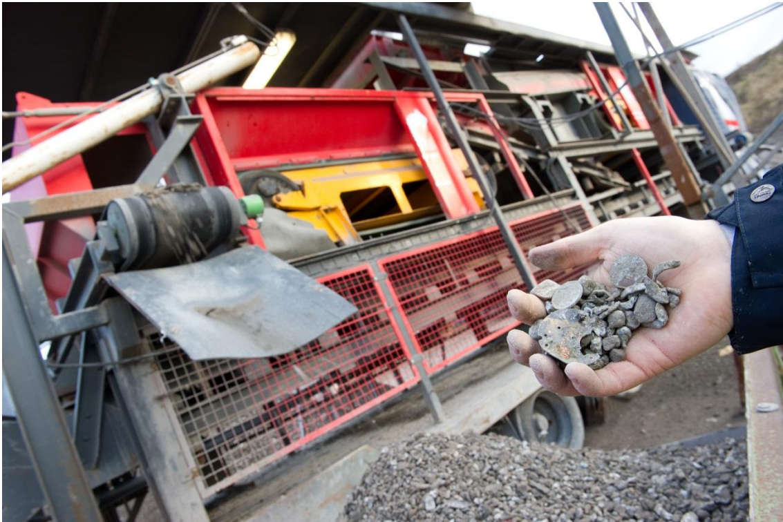
Abb. 2: NE-Metallgewinnung aus Verbrennungsschlacke
