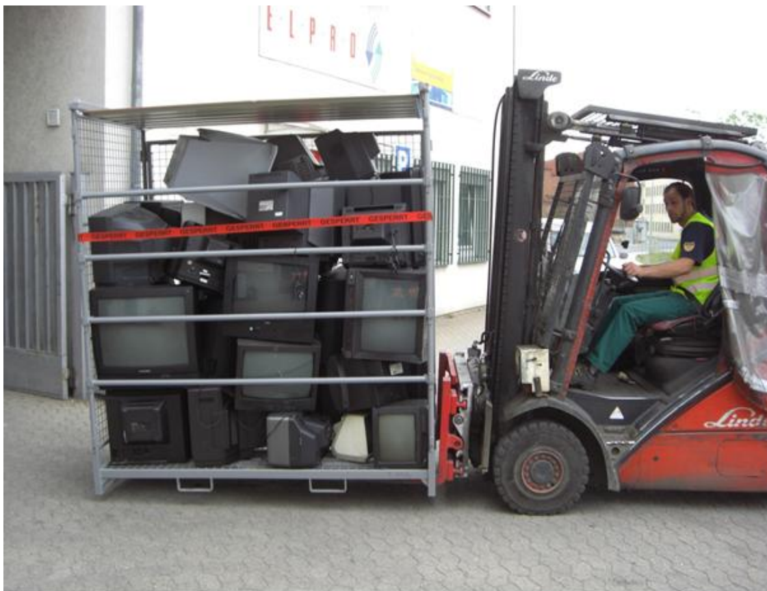
Abb. 3: Neu entwickelter Sammel- und Transportbehälter für Bildschirm(alt)geräte
