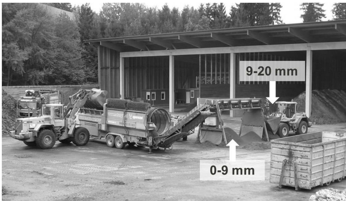
Abb. 3: Nachsiebung von Waldrestholz-Unterkorn für den Versuch
