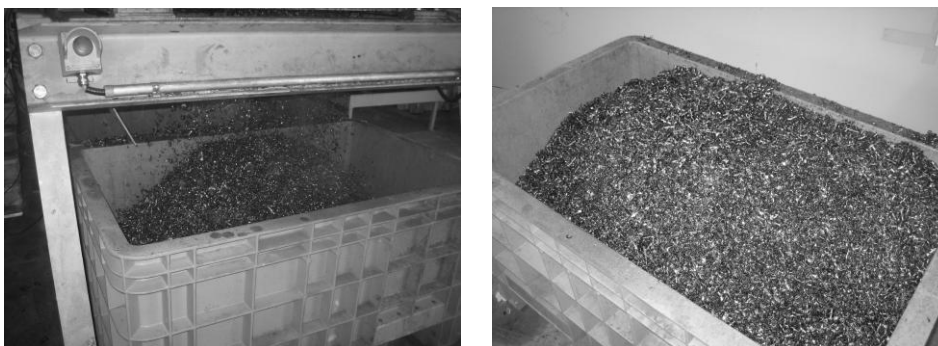
Abb. 2: Zerkleinerungsprodukte der Versuchsreihen 1 und 2 (Stahlspäne)
