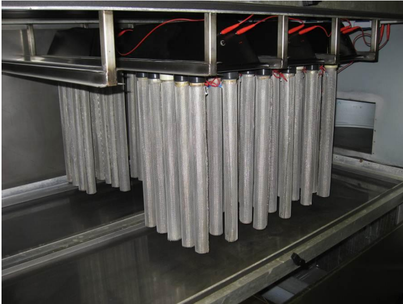
Abb. 5: Ionisationskammer mit Ionisationseinheiten (Montermann 2009)
