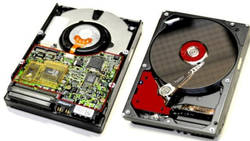
Abb. 1: Platine auf Festplatte (l.) und geöffneter Festplattenkörper mit Linear- und Spindelmotor (r); rot markiert (eigene Aufnahme)
