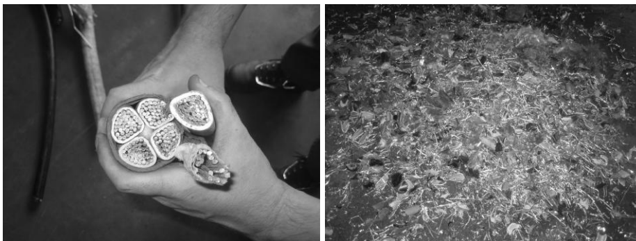
Abb. 4: Aluminiumkabel für Versuchsreihe Messung 7, 8 und 9 (Aufgabe linkes Bild und Zerkleinerungsprodukt rechtes Bild)
