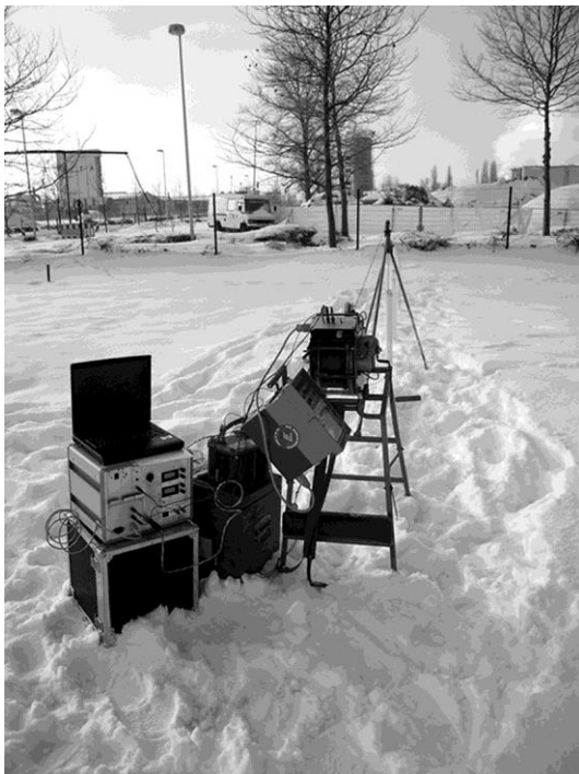
Abb. 2: INN-Messanordnung mit im Rahmen des Forschungsprojektes miniaturisierter INN-Sonde
